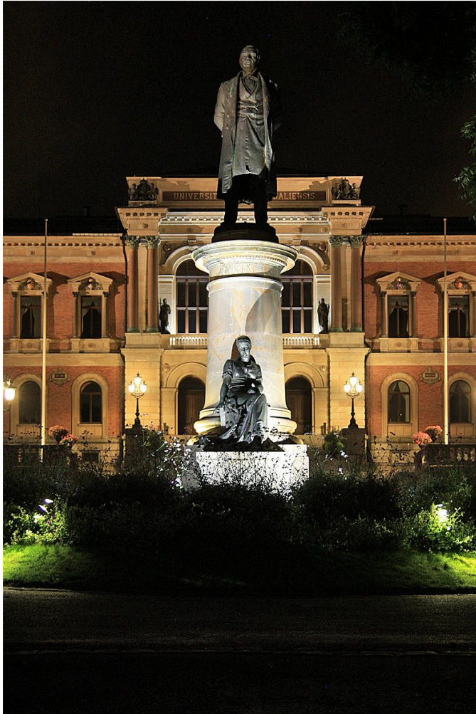
Geijerstatyn med ny belysning. Belysningen sker dels genom uppåtriktade strålkastare intill statyns fundament, dels genom strålkastare på stolpe på längre avstånd från statyn. Belysningen accentuerar främst den undre delen av statyn, med den sittande musan.
