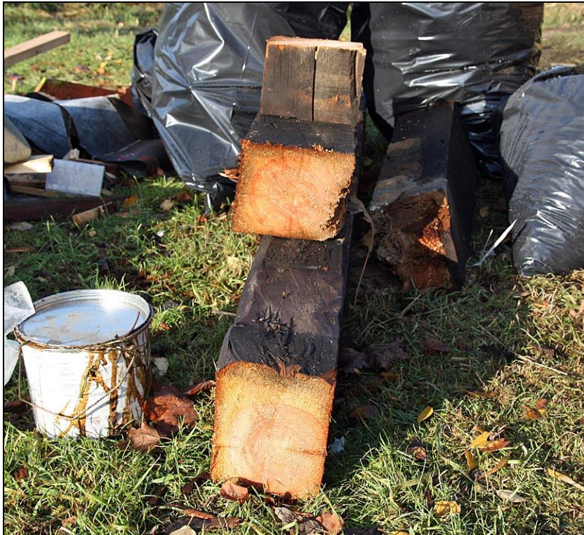
2010-11-01. Demonterade stockbitar från de gamla, angripna takbjälkarna. Stockarna tycks ha varit arsenikimpregnerade och förmodligen behandlade med kresot.
