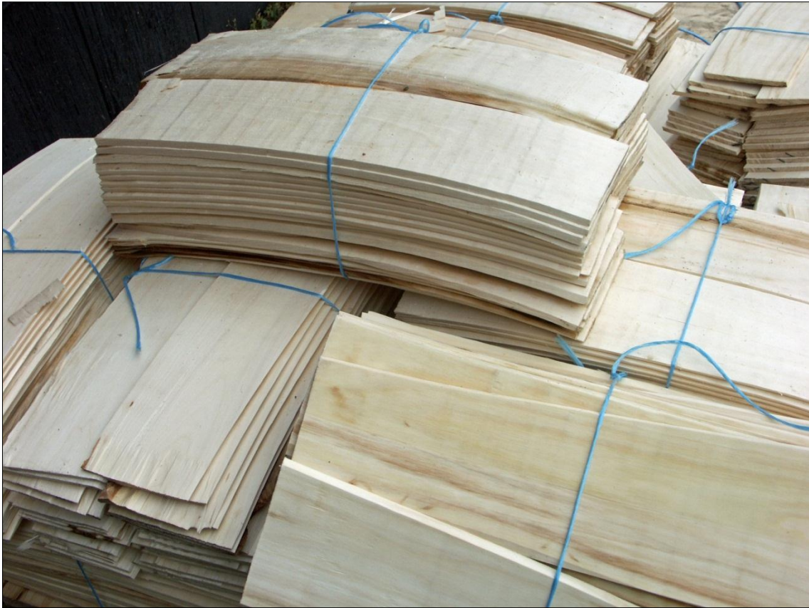
Nyhyvlade stickspån i asp, från rakvuxen och kvistfri asp
