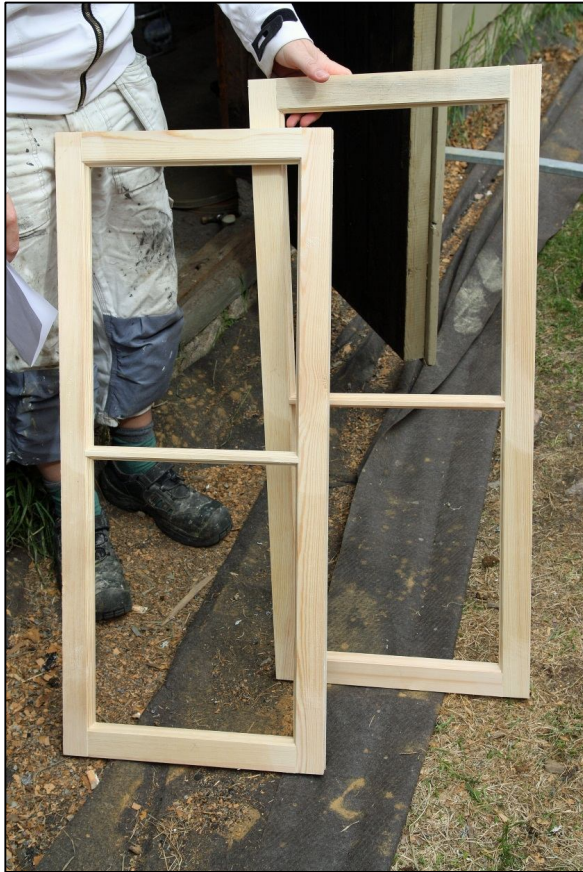
2012-05-30. Nytillverkade fönsterbågar till västra stallängans övervåning.
