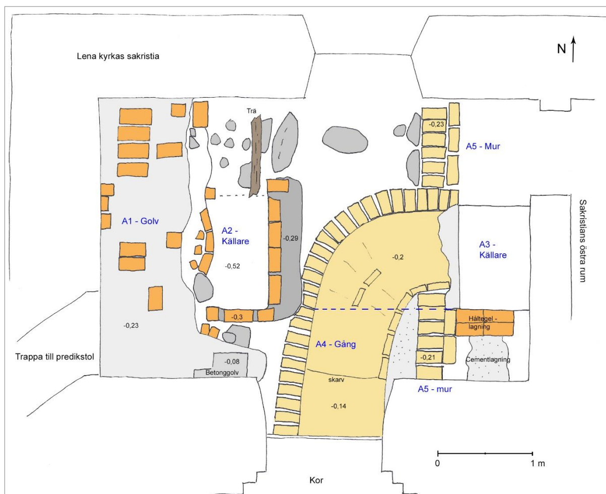
Figur 11. Planritning över sakristian i Lena kyrka med påträffade lämningar markerade med blå text. Streckad blå linje anger placeringen för den södra väggen i källare A3. Måttangivelser i meter. Skala 1:40.
