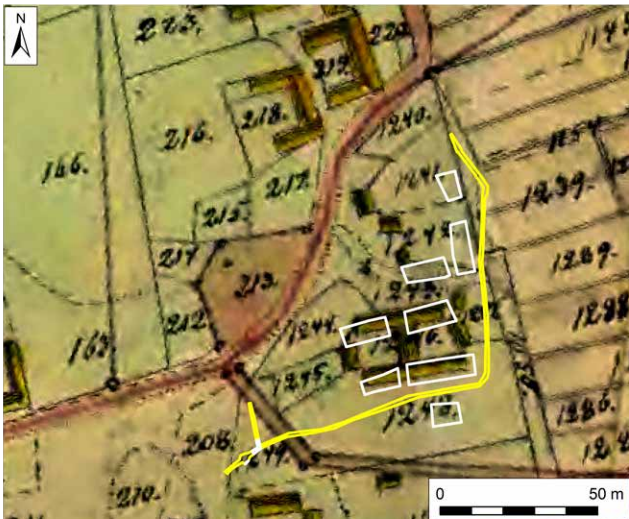
Figur 26. Rektifierat utsnitt ur karta över Hallarby från 1863, som visar delar av bytomten med hus. Flera inmätta husgrunder (vit linje) överensstämmer med kartan. Schaktet (gul linje) grävdes så att det undvek husgrunderna. Skala 1:1200.
