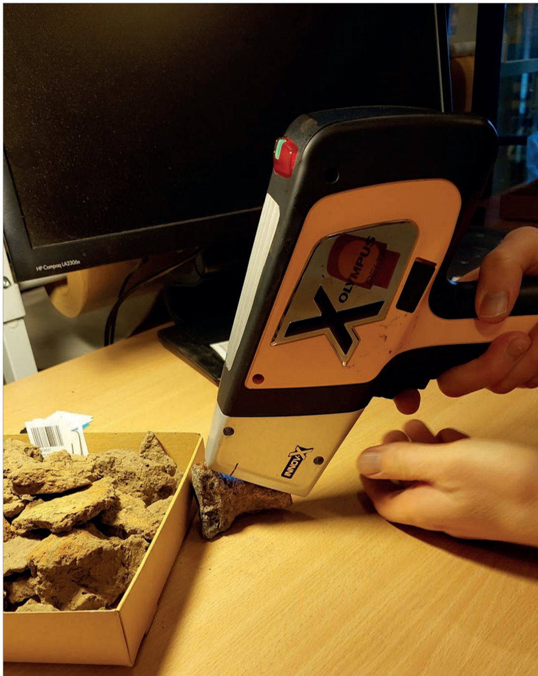
Figur 51. Mätning med handhållen XRF av ett fragment av en degel. Mätningarna var icke-destruktiva och gjordes i SHM:s magasin. Foto T. Eriksson, SHM.
