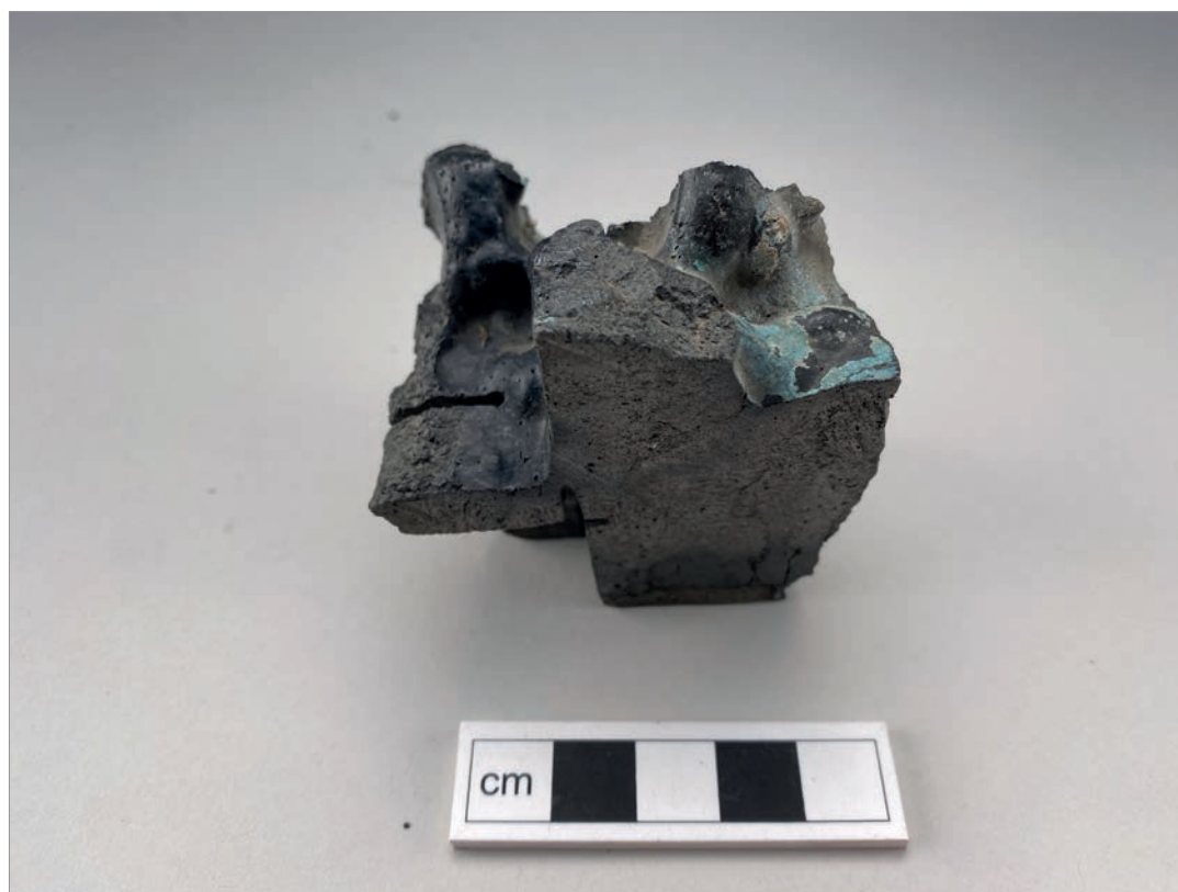
Figur 73. Slaggen som hittades i ytan på skärvstensflaket A29, strax norr om gjuteriområdet. Analyser visar att det rör sig om en kopparslagg från sulfidmalmer av det slag som finns i Bergslagen. Slaggen är sannolikt från historisk tid. Den är sågad på två ställen, antagligen för analysen på 1970-talet och på 2010-talet. Fid 971139_HST. Foto T. Eriksson, SHM.
