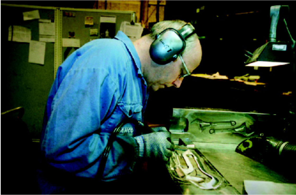
Fräsning av kantradier på matriser är ett arbete som kräver kunskap om hur fräsen arbetar i materialet och förmågan att med ögonen kunna avgöra när kanten fått den rätta runda formen.
