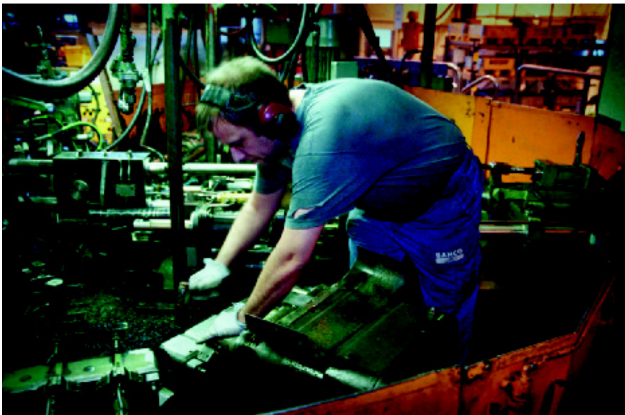
Vid uppsättningar byts alla produktionsverktyg. Efter uppsättningen måste justeringar ofta göras innan produktionen flyter på igen.
