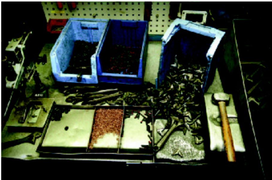
Skaft, löpare, ställskruv, fjädrer och stift. Tillsammans utgör de fem delarna en skiftnyckel.
