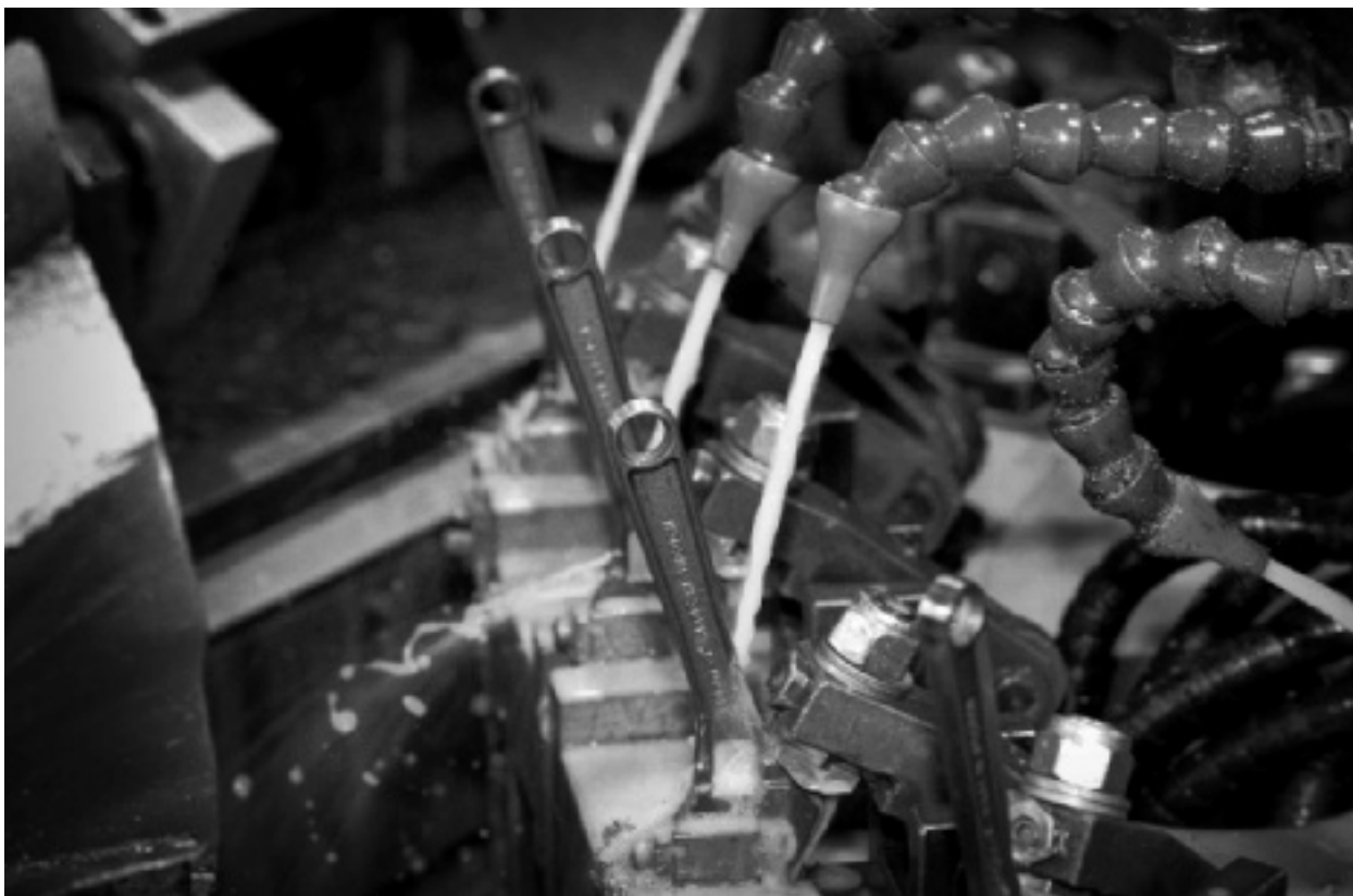
Kylvatten sprutar ur munstyckena medan maskinerna fräser, borrar och brotschar.
