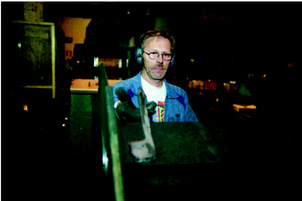
Runda järnstänger till mindre verktyg och platta till de större. Material till större skaft klipps till vad som i formen liknar en klubba.
