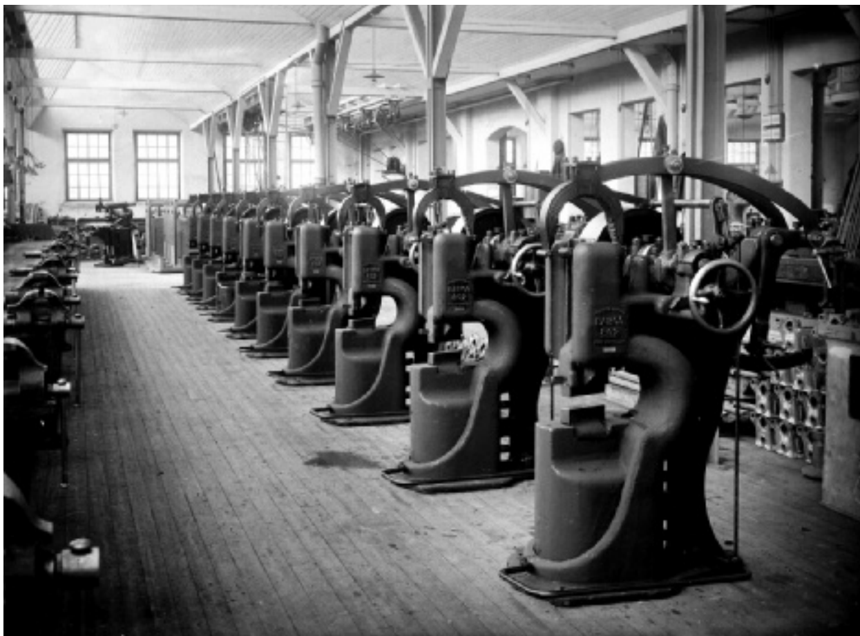
En hammare med reglerbar hastighet behövdes i produktionen vid Enköpings mekaniska verkstad. JP Johansson hittade själv en konstruktion och tillverkade även smideshammaren med namnet Vulcanus till försäljning.
