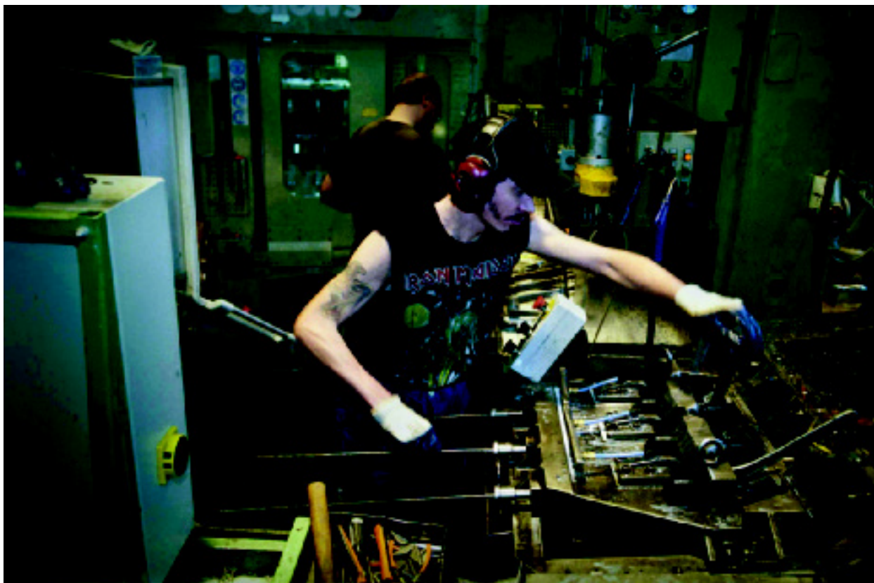
Brotschen är det produktionsverktyg som kanske tydligast visar på kraven på exakthet. Fräsar och borrar ger märken och kan inte ge lika snäva toleranser. Dragbrotschning, där hål i skaftet för löparen dras upp.
