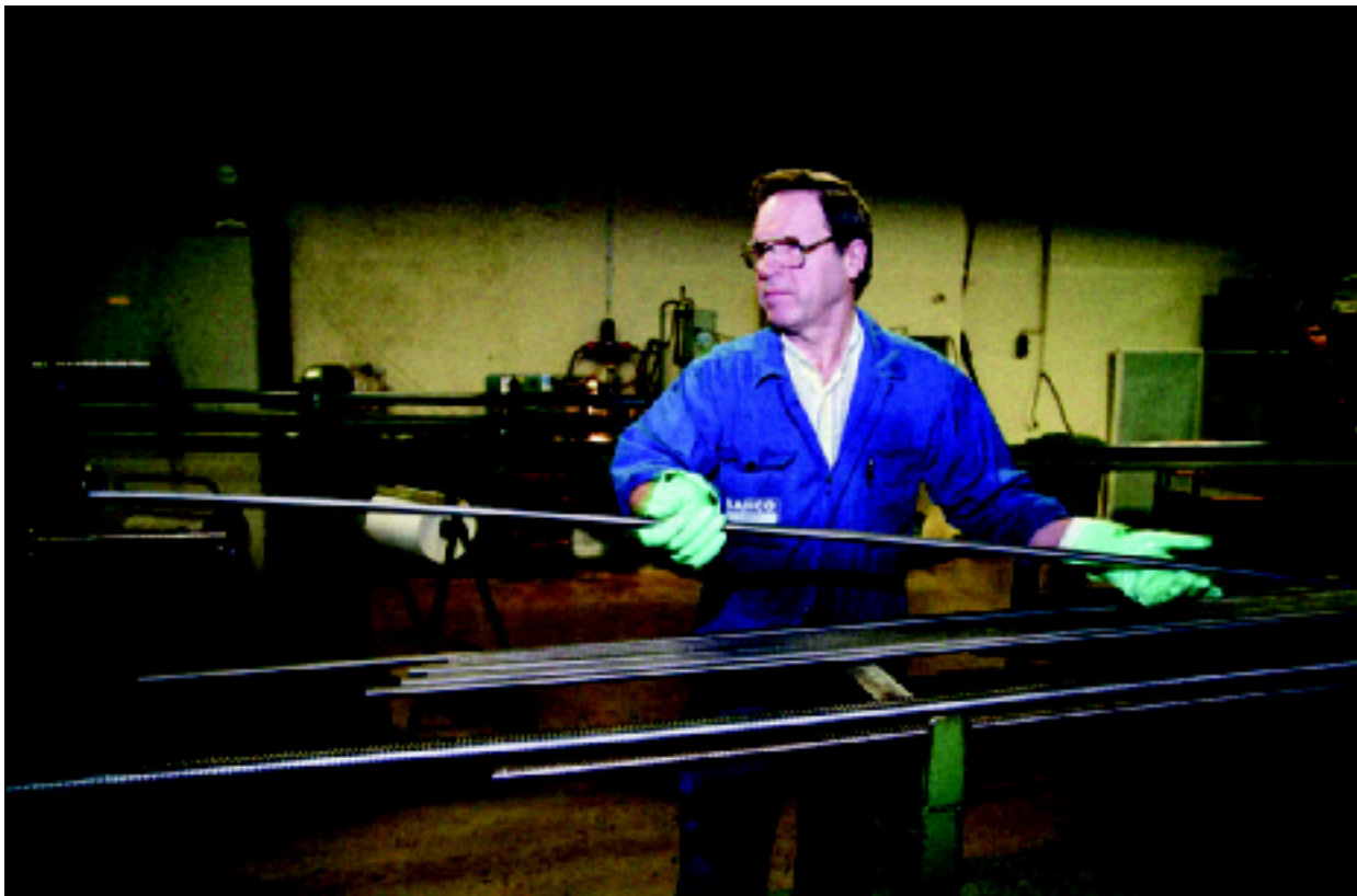
Ställskruvar tillverkas. Efter gängning och kapning ska de dessutom räfflas.
